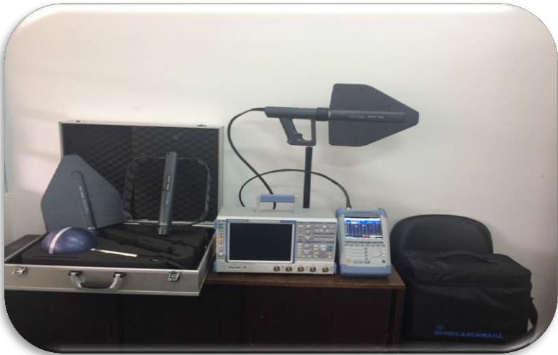
Figura VII Analisador de espectro FSH8, osciloscópio e antenas.
