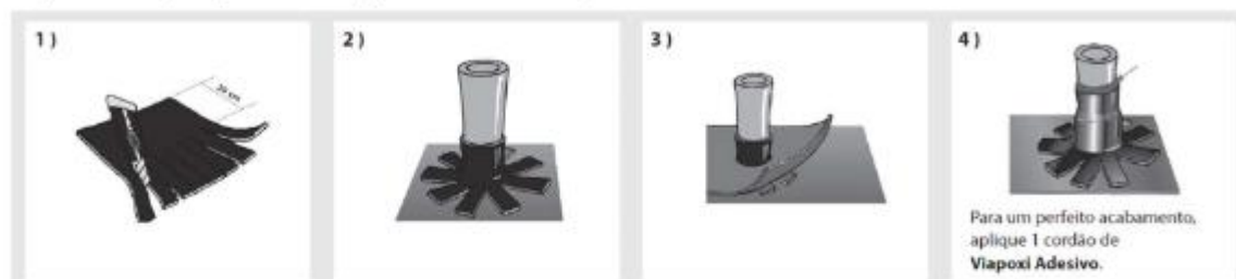
Imagem 7 – Impermeabilização nos trechos onde apresentam tubos
